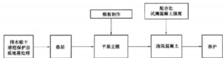
地基处理和排水管道基础施工流程
