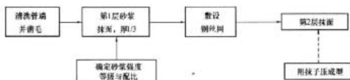
排水管道接口施工工艺流程图
