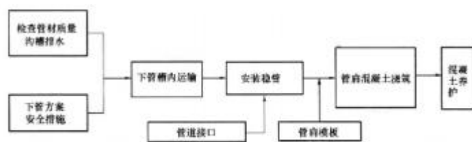
排水管道安装施工流程
