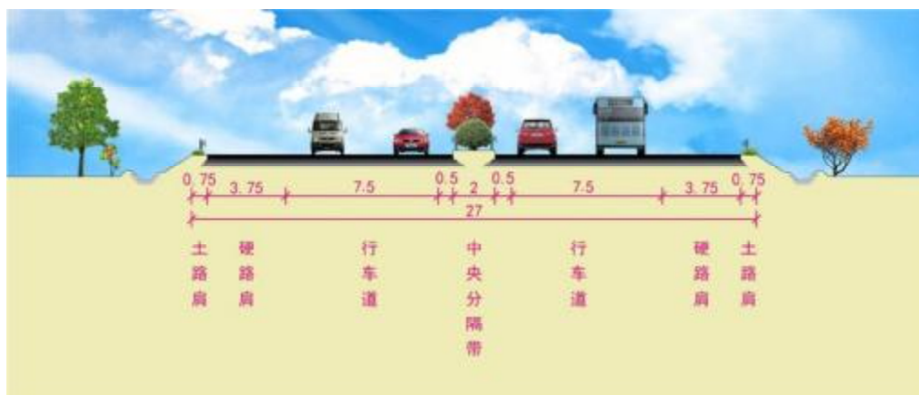
图 4-1 一般公路段路基标准横断面图
