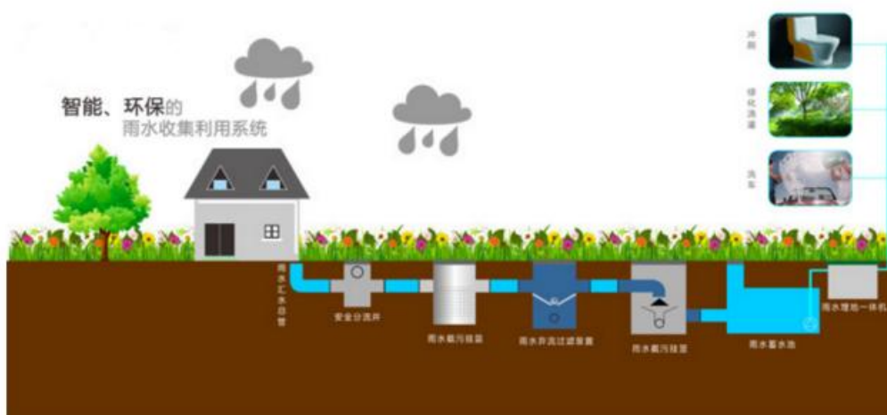
图 5-8 项目雨水收集系统流程图
